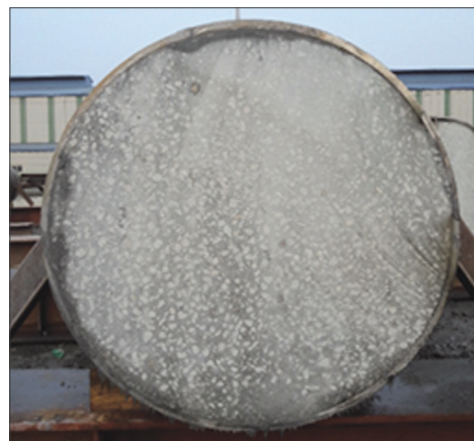
콘크리트 충전 시험 (하현재 절단면)
